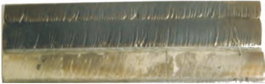
图 4 复合测试靶板试样实物图
