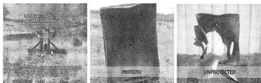
图 11 聚脲涂覆钢板复合结构抗爆试验情况
