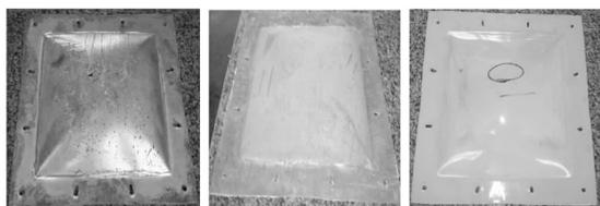
图7 纯钢板与聚脲前后涂覆钢板抗爆性能的试验结果
