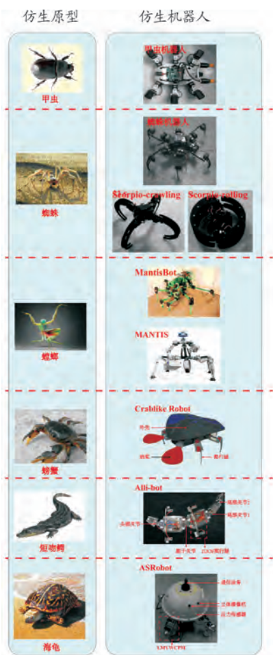
图 4 仿生足式爬机器人及其仿生原型效果图
