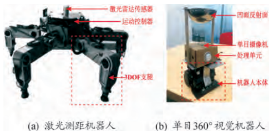
图 15 视觉传感器在机器人上的应用效果图
