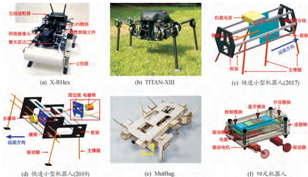
图2 无变构设计足式爬行机器人效果图
