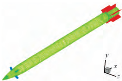
图 2 炮射飞行器外形全局网格图
